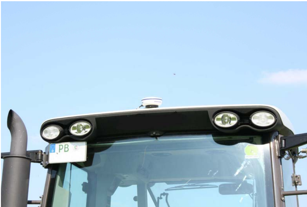
Rys. 5-1 Montaż anteny GPS
