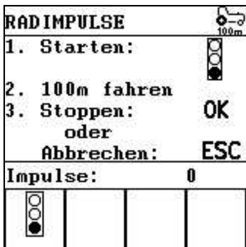
rys7-9 Kalibracja czujnika prędkości
