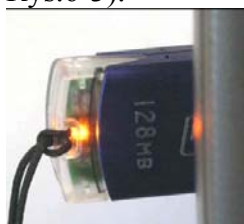
Rys.6-3 Dioda LED wskazująca stan pracy
