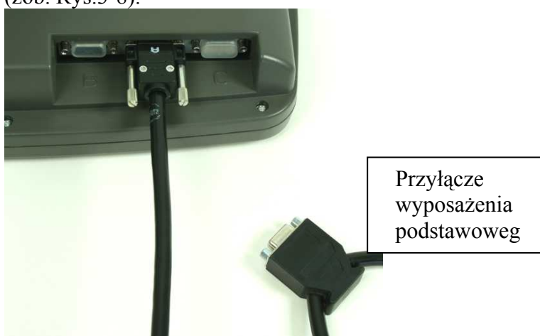
Rys.3-8: COMFORT - Terminal z kablem podłączeniowym uchwyty wielofunkcyjnego i przyłączem do wyposażenia podstawowego
