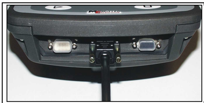
Rys. -9: BASIC - Terminal z podłączonym kablem do wyposażenia podstawowego
