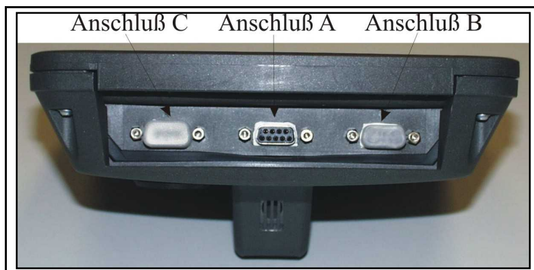
Rys. -8: Przyłącza na stronie spodniej BASIC - Terminal
