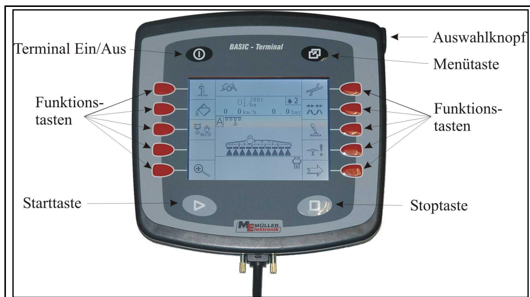
Rys. -11: Elementy obsługujące BASIC – Terminal
