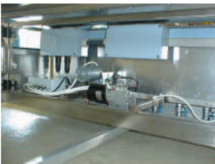
Abbildung 2: Meßwagenantrieb, Ventile und Stahlgehäuse für die Elektronik
