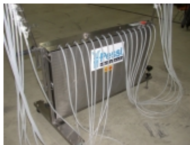
Abb. 5: Rückwärtige Ansicht (ECO-Version) mit Schlauchhaltern und Düsenadaptern
